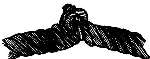
Рисунок 15. Перекручивание каната
