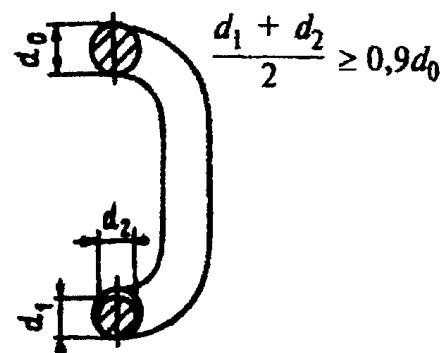
Рисунок 2. Уменьшение диаметра сечения звена цепи:
