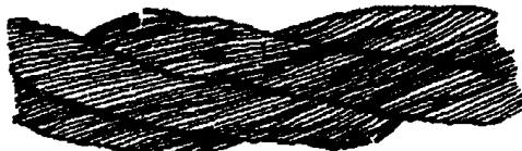
Рисунок 1. Обрывы и смещения проволок каната крестовой свивки
